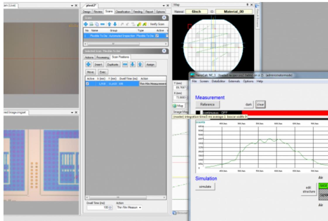
Leistungsfähiges System für Schichtdicken zwischen 50 nm und ca. 50 µm.
