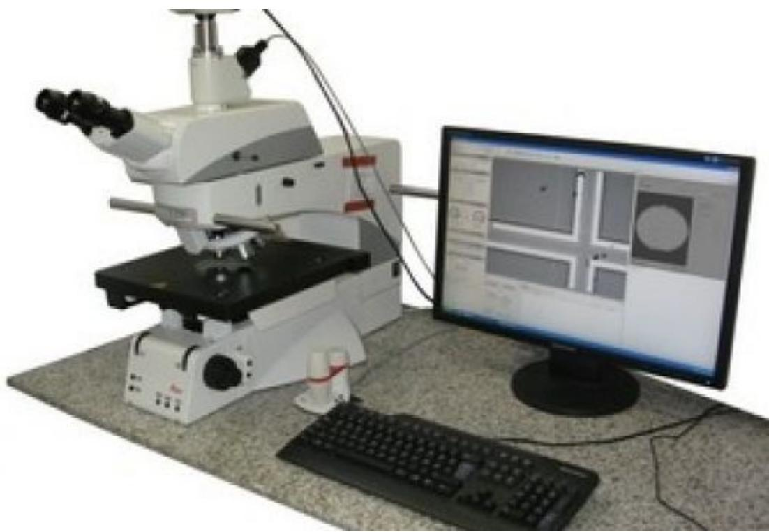
Universelles Halbleiter-Mikroskop mit der Option zur Schichtdickenmessung.
