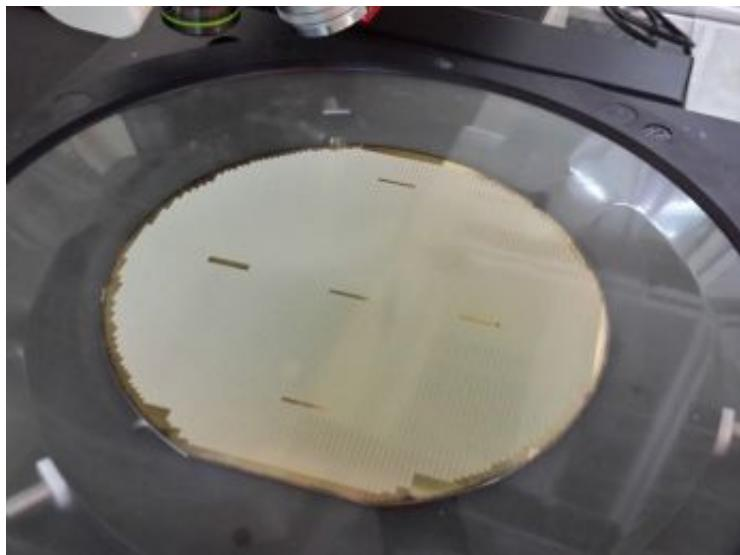
Vakuum Chucks mit feinstporöser Oberfläche für gesägte Wafer auf Blue Tape. Auch Wafer mit sehr kleinen Dies werden sicher und eben angesaugt.
