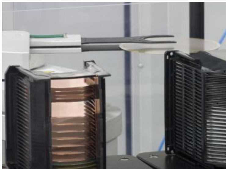
Promicron bietet erprobte Lösungen, um auch für Wafer mit deutlichem Bow / Warp ein sicheres Handling zu gewährleisten.
