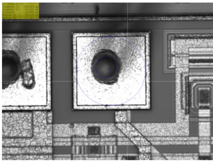
Prüfung von Wedgebonds und Ballbonds mit 3D Mikroskopie.
