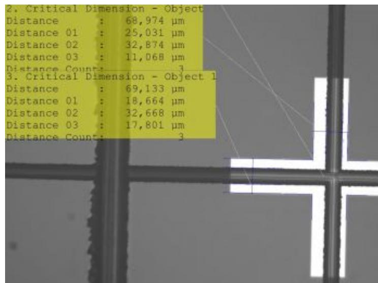
Inspektion und messtechnische Kontrolle der Sägestraßen (dicing line) auf
