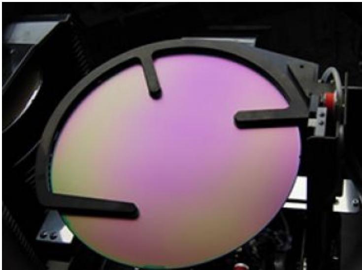
Gebondete Wafer sind erheblich dicker als Einzelwafer und können einen Versatz aufweisen. Sie können zudem unrund sein. Zur Lösung verschiedenster Mess- und Inspektionsaufgaben greift Promicron auf eine Vielzahl unterschiedlicher optischer Verfahren zurück und kombiniert diese je nach Anforderung und Kundenwunsch.
