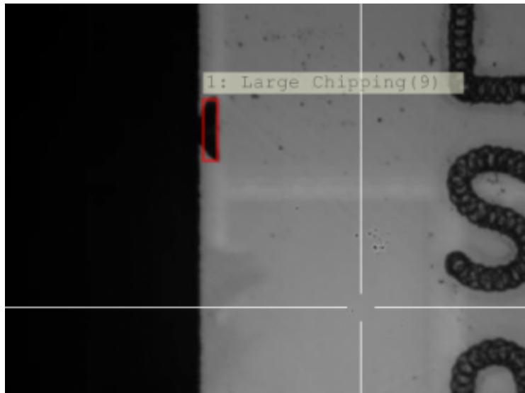
Beispiel einer Chipping Prüfung mittels Infrarotkamera.
