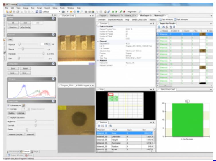
AOI-Kontrolle des Druckbildes gegen importierte CAD Daten.
