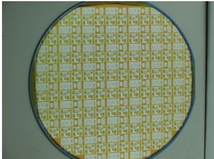
Makro-Inspektion und Dokumentation: Das Waferhandlingsystem ist mit verschiedenen anwählbaren Lichtquellen ausgestattet. Dazu gehört die homogene Leuchtfeldplatte für eine Hellfeldinspektion sowie eine Dunkelfeld-Lichtquelle zur Inspektion auf Partikel, Kratzer u.s.w..
