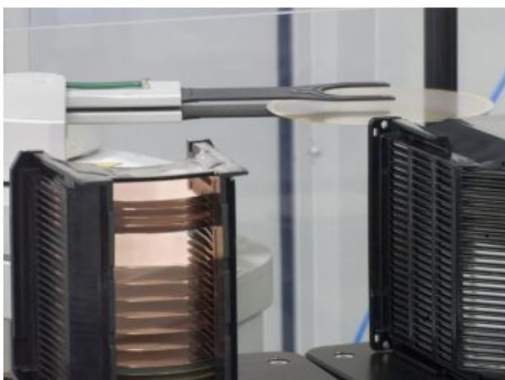
Unsere Mikroskopstation Promis-A mit Dual-Arm Roboter und Hochleistungsmikroskop kann für vielfältigste Untersuchungen genutzt werden. Auch transparente Materialien können von Handling und Aligner bearbeitet werden.
